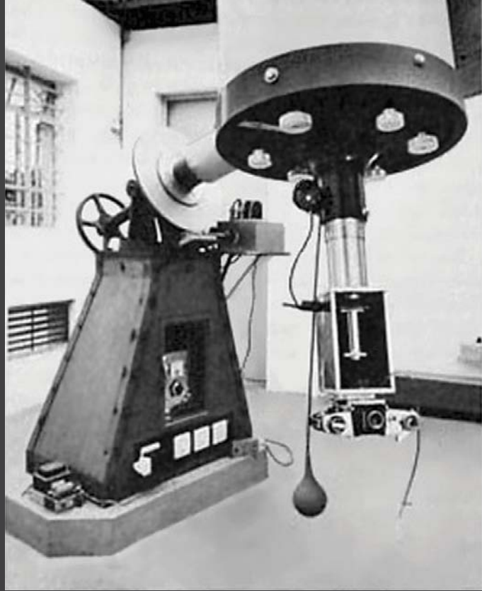
裝在 32cm 反射鏡卡氏焦點的鋼葉相機快門，由手動氣泵操作。早期單鏡反光相機的快門震動頗大，為此廖生自行設計這個避震組件，適合高倍放大的月球行星攝影。
