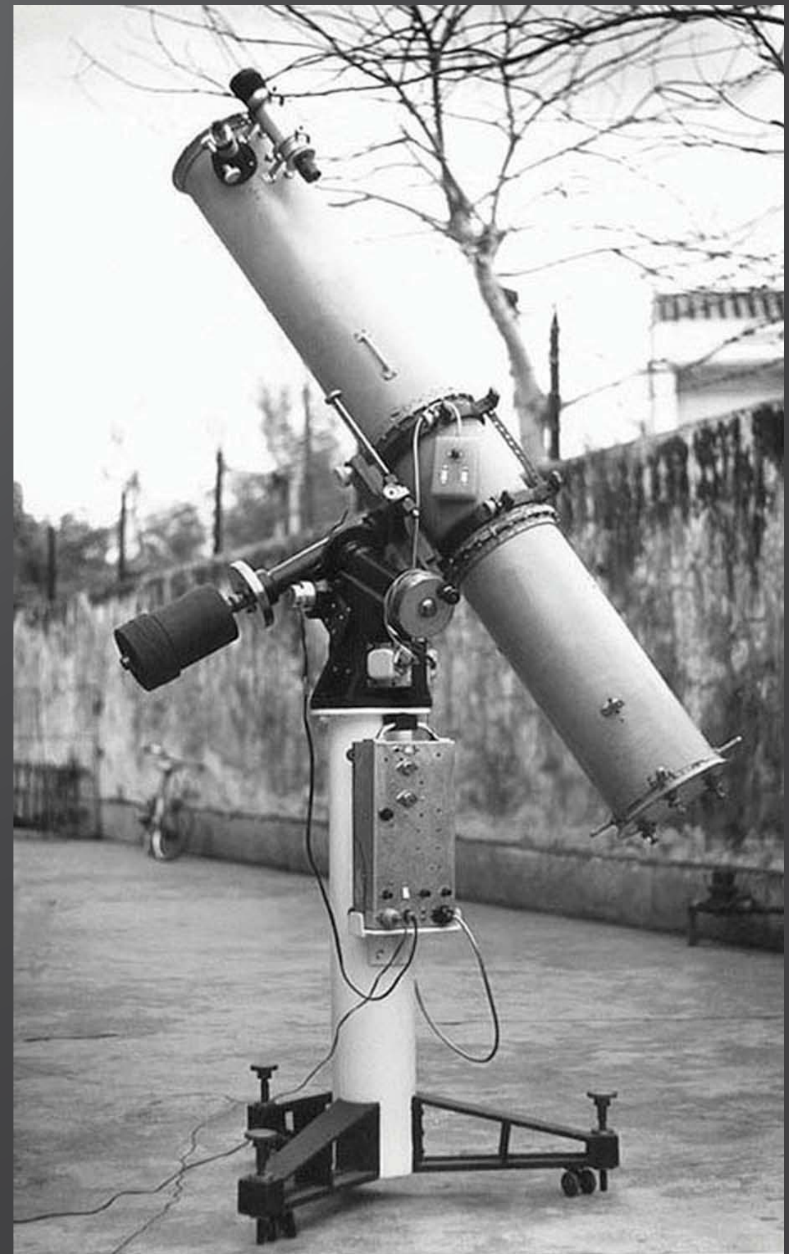
廖生的第二枝天文望遠鏡，可以進行有效的天文觀測。它是一枝英國二手的 16.5cm (6.5 吋) f/10 牛頓反射鏡，以懸錘的重力調節轉速，後來改用電子控制（見柱身的鉛箱）。由於主鏡邊緣破裂，它的口徑實得 16cm 左右。從 1953 年起，此鏡一直是廖生的忠實老伴直至 1972 年退讓給後來的 32cm 反射鏡。照片攝於 1966 年香港上水村。
